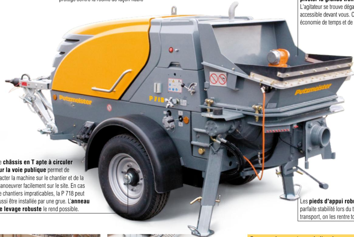
Le **châssis en T apte à circuler sur la voie publique** permet de tracter la machine sur le chantier et de la manœuvrer facilement sur le site. En cas de chantiers impraticables, la P 718 peut aussi être installée par une grue. L'**anneau de levage robuste** le rend possible.
