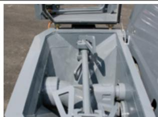
Un vibreur est monté sur la grille de sécurité pivotable de la trémie. Il assure un flux de matériau continu. La **grande trémie a une capacité de 360 l** et est conçue de sorte à pouvoir être vidée presque entièrement en refoulant.
